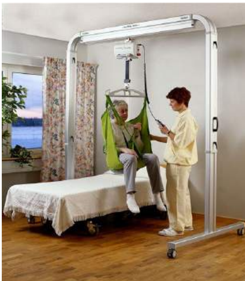
Ryc. 123. Winda osobista to transferu pacjentów z łóżka na wózek inwalidzki. Źródło: dolphinlifts.co.uk.
